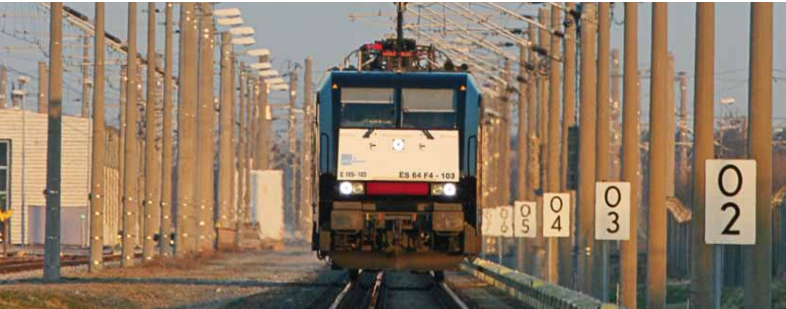
Technologie-Retrofit: Mit nachgerüsteten Zugsicherungssystemen (ETCS, ATB, SCMT) können die Lokomotiven Typ ES64F4 grenzüberschreitend verkehren.
