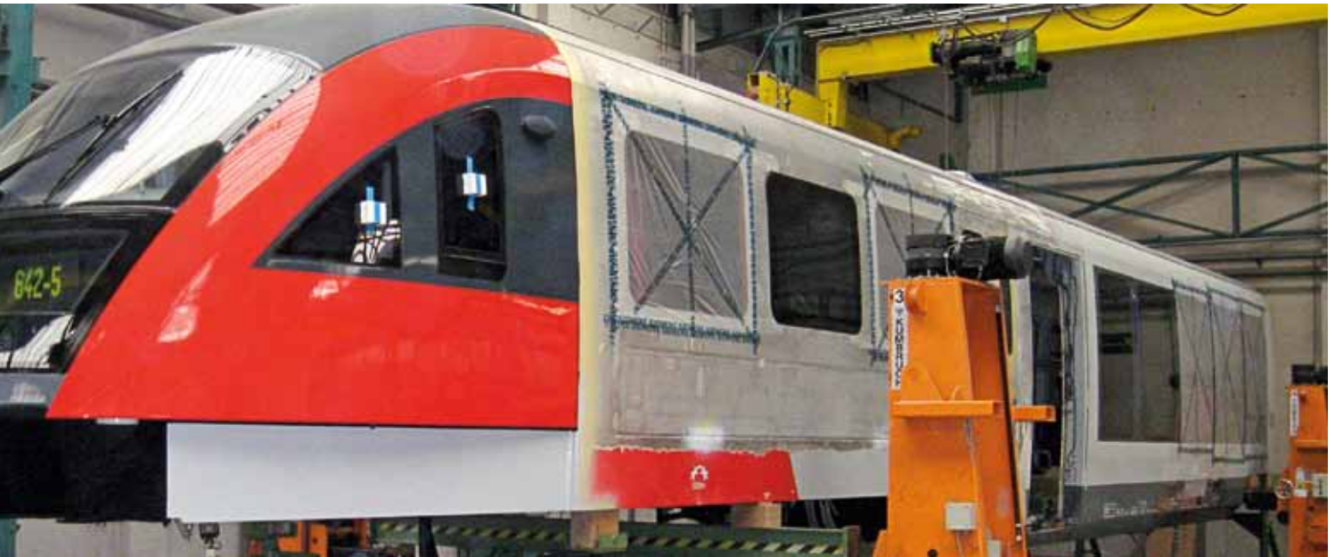
Wiederaufbau des Fahrzeugkopfs: Die umfangreiche Reparatur des starken Front- und Seitenschadens bringt den Desiro Classic ÖBB zügig wieder in Betrieb.
