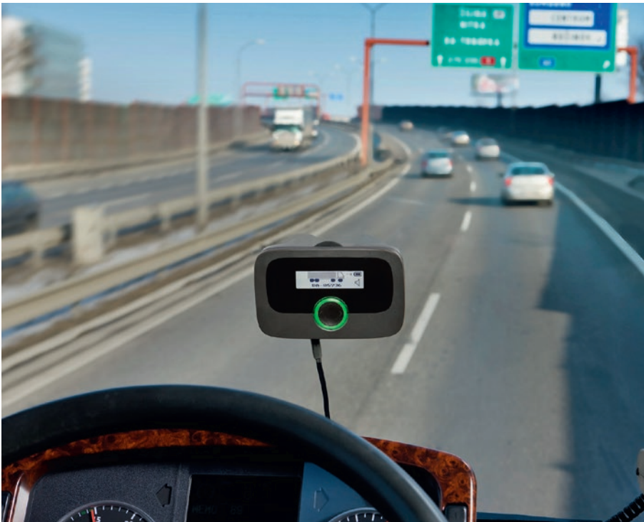
Die satelliten-gestützte OBU, das Herzstück der Lösung, erkennt bemaute Straßen und Strecken
